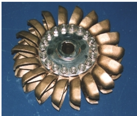
Figura 8-5 Rodete Pelton fabricado a nivel local en Sri Lanka, Dp = 180 mm
